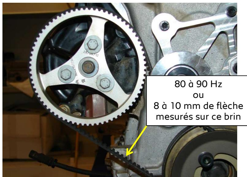
En cas de doute sur l'alignement du galet tendeur de courroie de pompe à eau, nous vous recommandons de contrôler l'épaisseur de l'entretoise de support du galet tendeur selon le plan ci-dessous :
