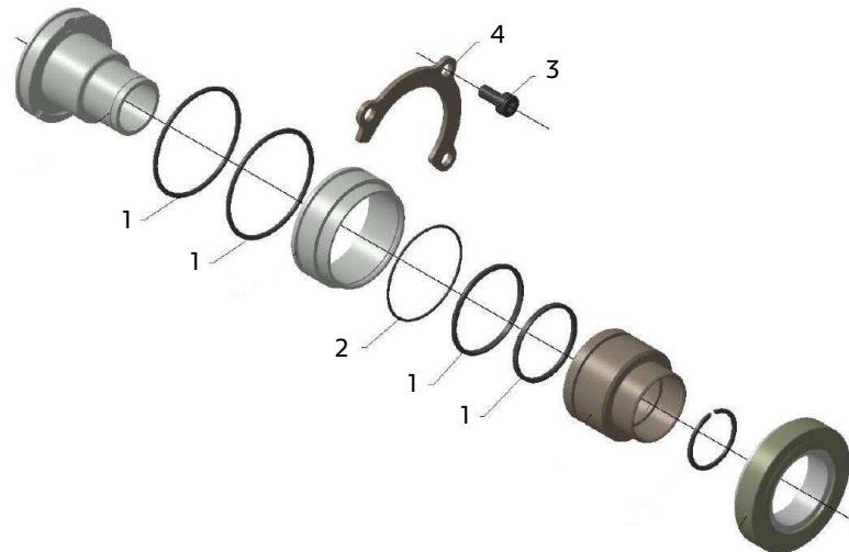
Nous vous recommandons de contrôler régulièrement l'état de ces joints et de les remplacer si nécessaire :
