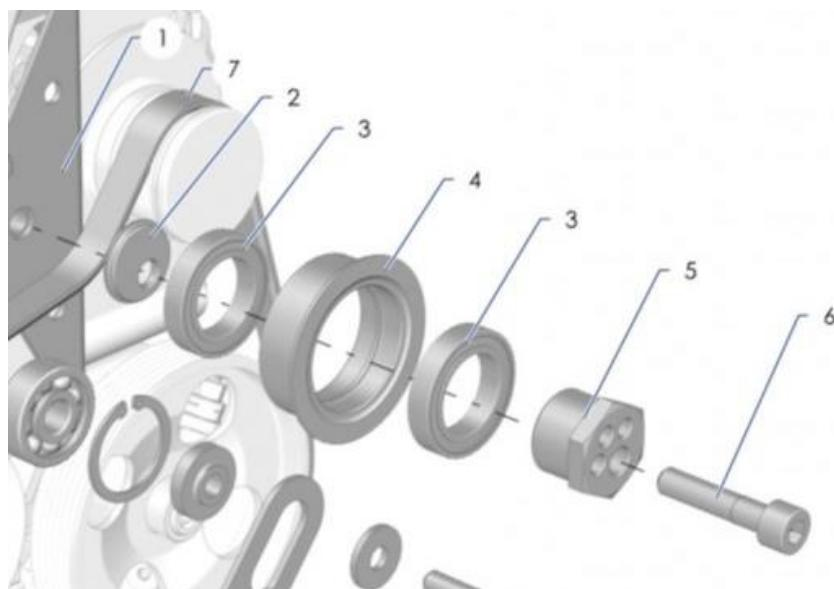
En effet, **les roulements conformes ont des bagues d'étanchéité en plastique de couleur verte alors que celles des roulements non conformes sont de couleur noire.**
