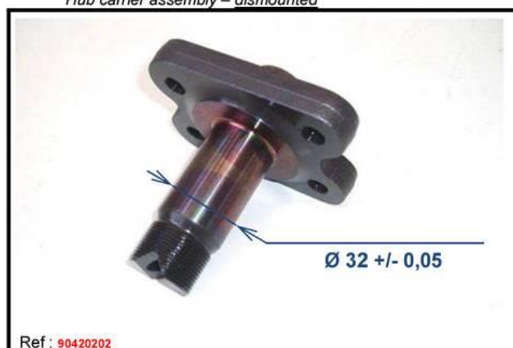
H3-1) Porte moyeu assemblé – déposé Hub carrier assembly – dismantled
