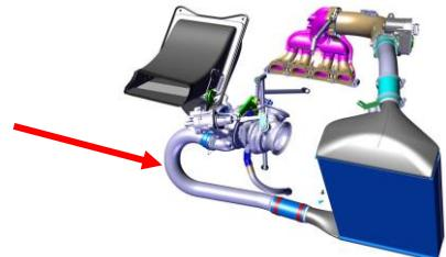
Afin de fiabiliser votre C3R5, voici quelques conseils de montage du tube de sortie turbo (904601738A).
