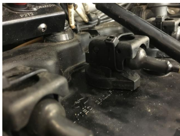
Mauvaise position des joints (vers l'avant)
