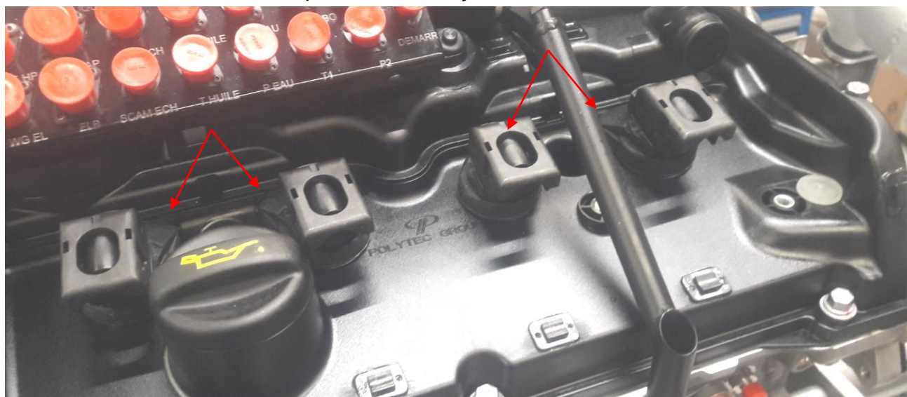
Position correcte des joints (vers l'arrière, dans les encoches)
