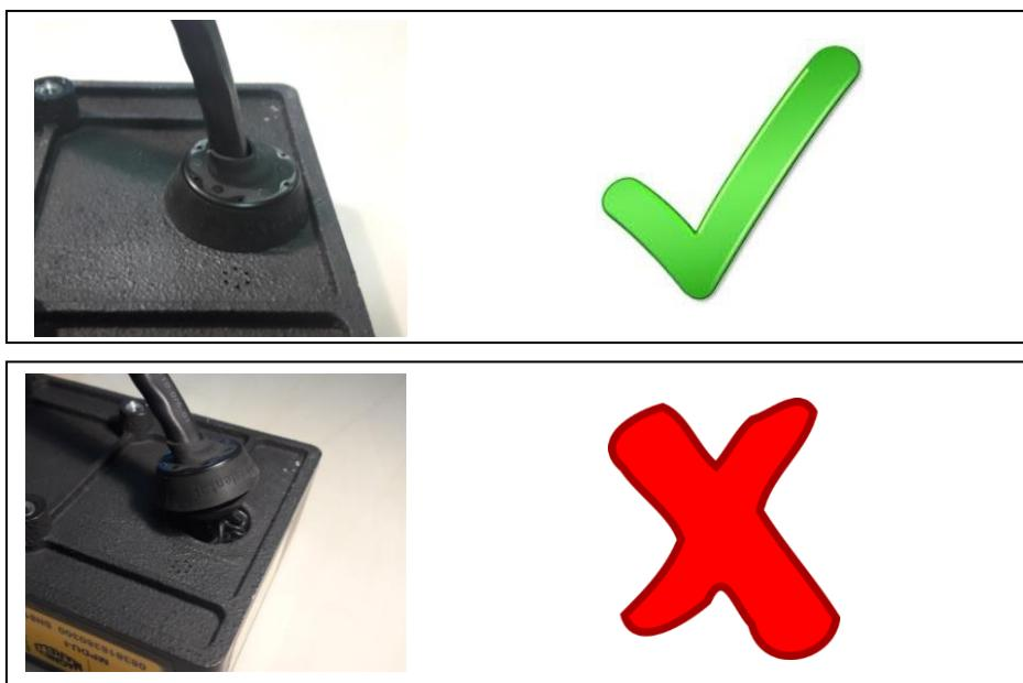
Pour verrouiller le passe-fil sur le boîtier, il faut, en poussant au centre du passe-fil, que les 2 ergots (diamétralement opposés) s'engagent bien à l'intérieur du dashboard. Un petit "clic" s'entend lors de la bonne mise place du passe-fil (ne pas utiliser de tournevis ou autre pour la mise en place).
