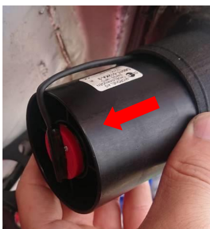
Sens de soufflage (grillage fin manquant)
