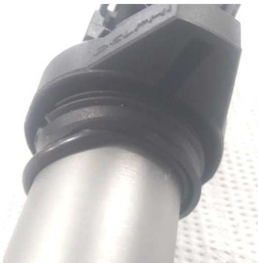
Mise en position du joint
