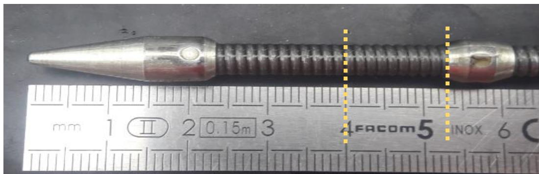
Niveau max (sous la boule) à 53mm, niveau min à 40mm
