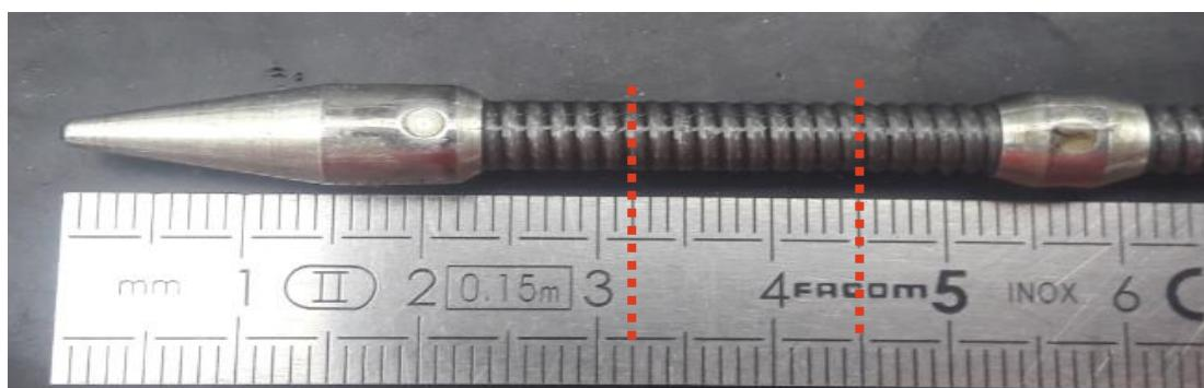
Niveau max à 45mm (8mm sous la boule), niveau min à 32mm
